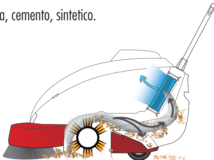
Filtri speciali per trattenere polvere di silicio e di nylon delle palline.
